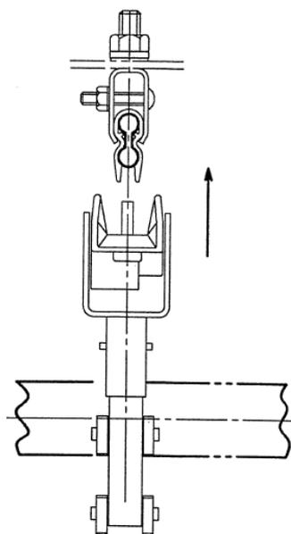
① シューを絶縁導体の摺動面に取り付けてください。
