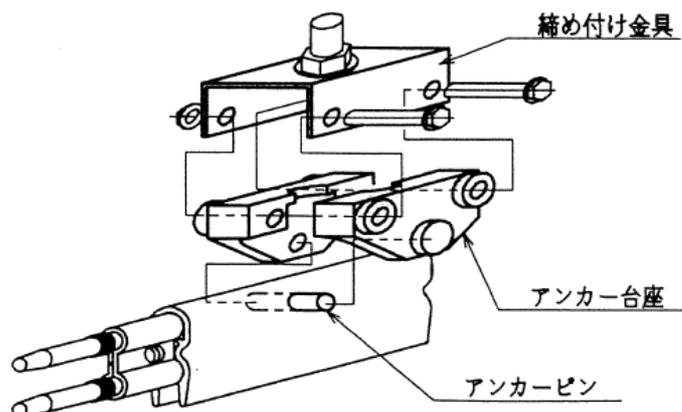
④ 加工した穴にアンカーピンを差し込みます。
