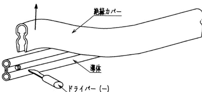
1) 絶縁カバーと導体の間にドライバー(-)を差し込み、絶縁カバーと導体を分離します。
